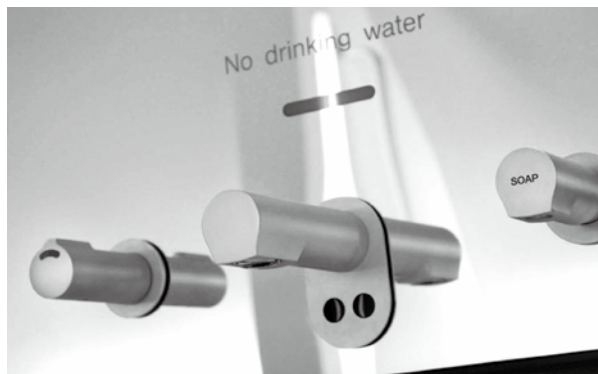
图1 A380头等舱盥洗室设计(水温指示器内置于镜面中)
