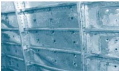
图15 壁板剪切失稳破坏
