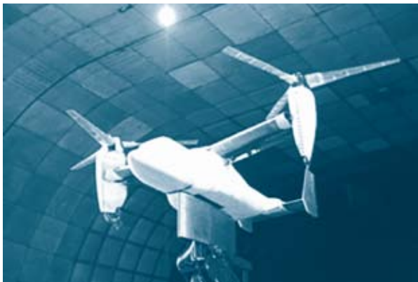
图3 V-22模型在NASA艾姆斯研究中心40×80英尺风洞中试验
