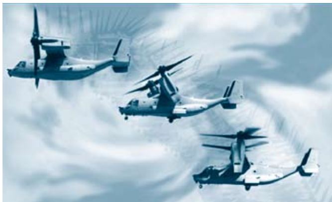
图5 V-22机从垂直起飞向平飞过渡的示意图
