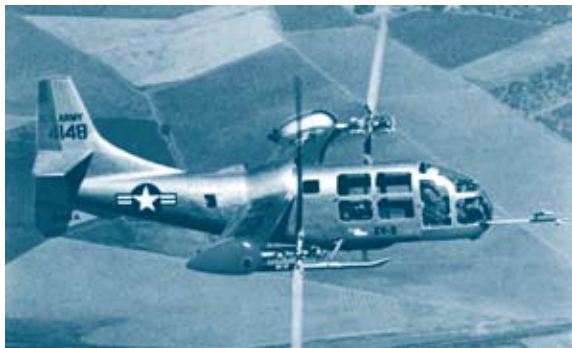
图2 二桨叶旋翼的XV-3以定翼机方式飞行
