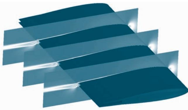
图4 传统阻力方向舵不同截面速度云图
