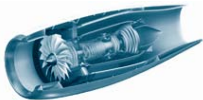
图2 带发动机短舱和反推系统的Tech-X发动机
