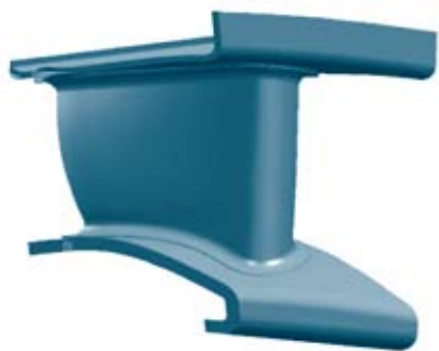
图4 陶瓷基复合材料低压涡轮导向器叶片
