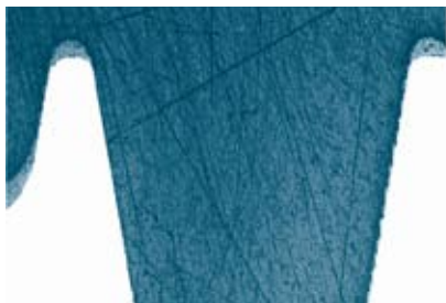
c. 封严齿涂层试样50倍金相照片
