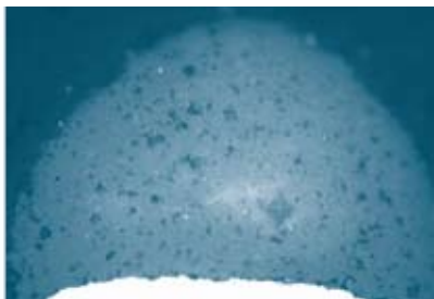
d. 封严齿涂层试样500倍金相照片
