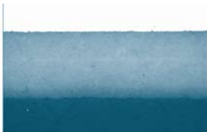
b. 平板试样涂层200倍金相照片
