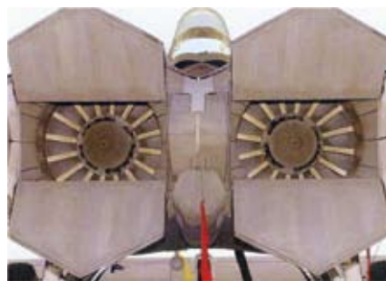
图5 径向加力燃烧室(从飞机尾部看)
