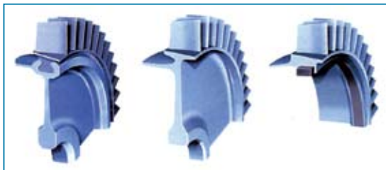
图2 盘片连接结构和整体叶盘、叶环结构
