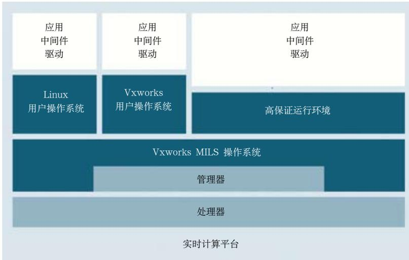
图5 采用微内核的VxWorks MILS 2体系结构
