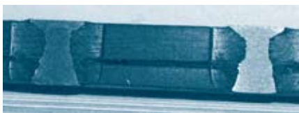
图2 采用锤铆方法铆接4mmHB6478钛铆钉后的横截面
