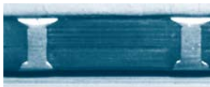
图3 采用电磁铆接方法铆接4mmHB6478钛铆钉后的横截面
