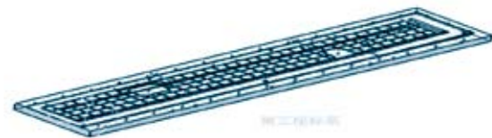
图6 长板立筋类零件正面加工示意图
