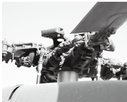
图1 S-70桨毂4支臂双线摆式吸振器
