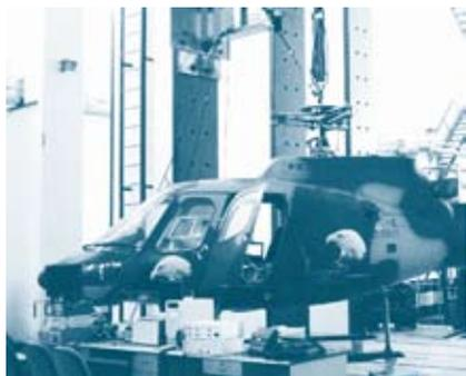
图6 ACSR系统装直11地面试验示意图
