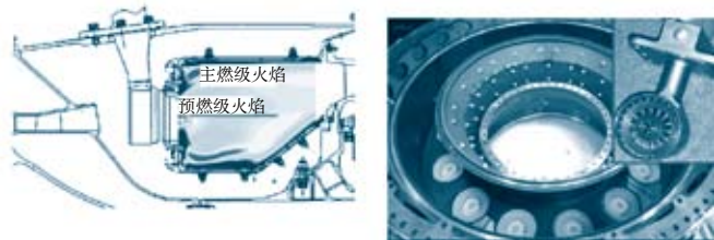
图11 E3E核心机燃烧室结构和全环燃烧室
