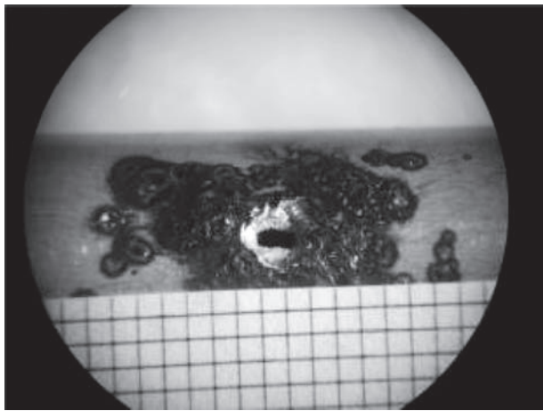
图4 铝合金管路所受电弧故障损伤
