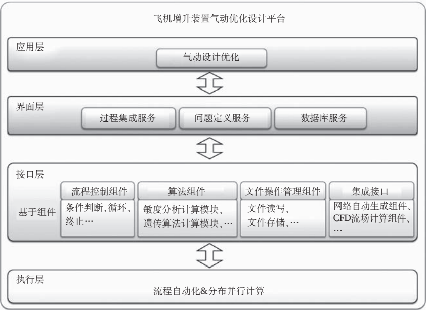
图1 增压装置气动优化设计平台
