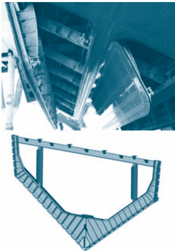
图1 Be200飞机的机身船底框和大型水陆两栖飞机机身下部船底框模型 Fig.1 Be200 bottom frame and amphibious aircraft bottom frame model
