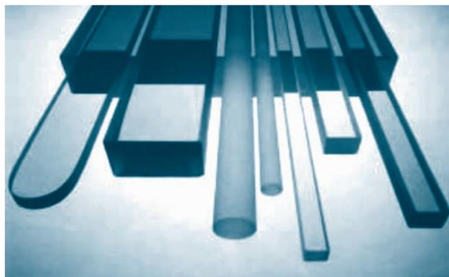
图1 激光陀螺腔体加工所用材料
