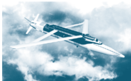
图10 SDB借助于联接翼实现了较大的无动力射程
