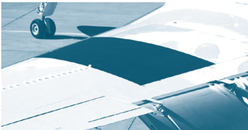
图11 用于NASA研究的“湾流”公务机,黑色表面密布微小鼓包
