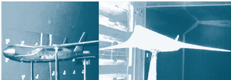
图4 风洞试验中的两种VELA研究方案
