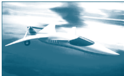
图8 洛克希德·马丁公司的低声爆联接翼超声速运输机方案
