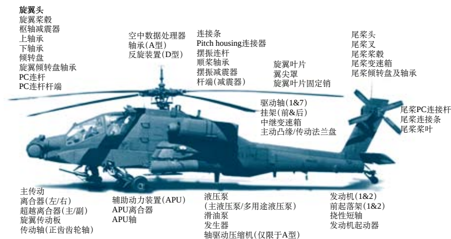
图4 AH-64 A/D阿帕奇主要监控零部件清单
