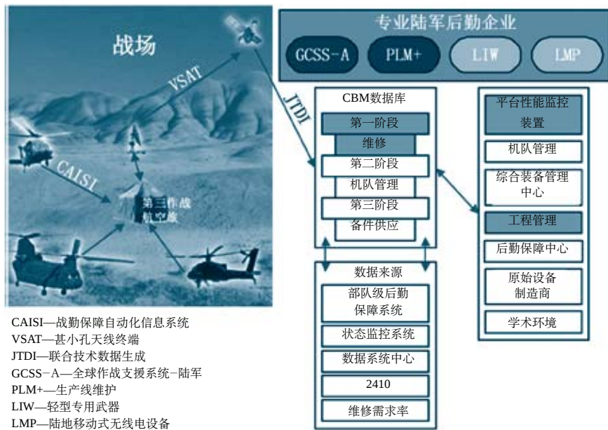
图7 美军伊拉克战场CBM数据传输图
