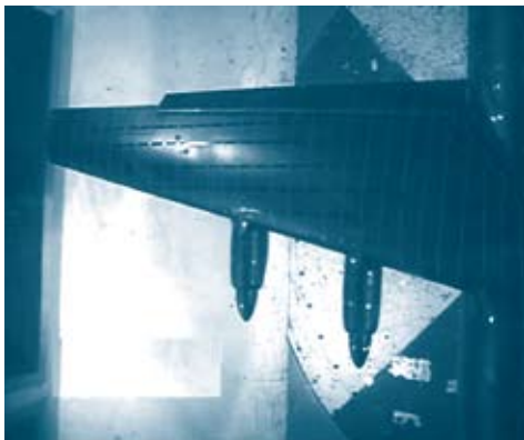
图16 优化后的全机着陆构型在风洞试验中用丝线显示的表面流态
