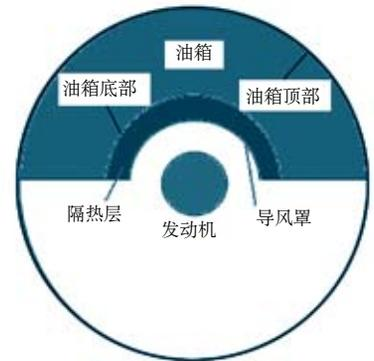
图1 飞机整体油箱结构剖面示意图
