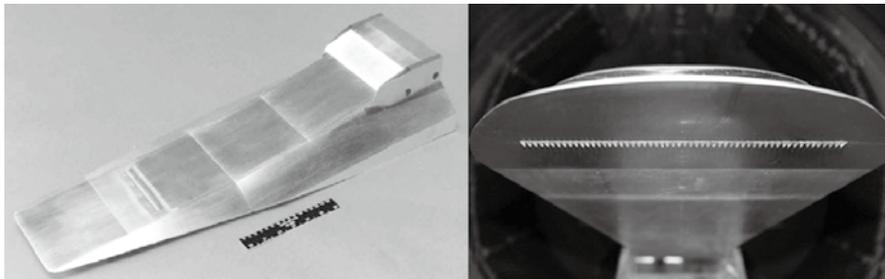
图1 美国X-43和X-51前体边界层强迫转捩风洞试验模型
