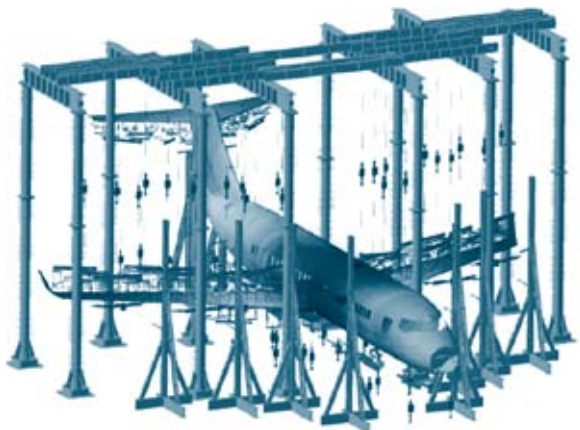
图3 飞机结构虚拟试验场景
