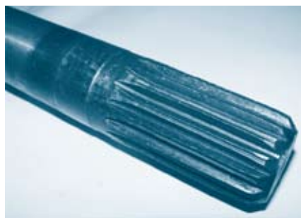
图6 冷滚打加工的渐开线花键轴实物图
