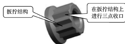
图 6 十二角自锁螺母结构优化
