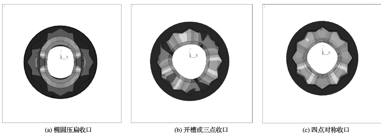
图1 自锁螺母锁紧区收口变形
