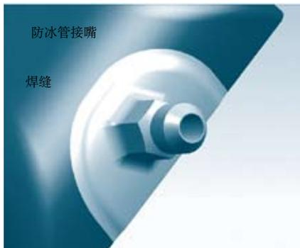
图15 防冰管接嘴与封头改进后连接形式
