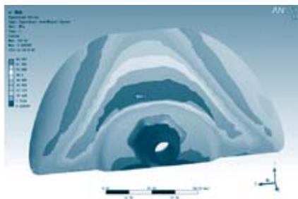
图16 改进后防冰管嘴应力云图
