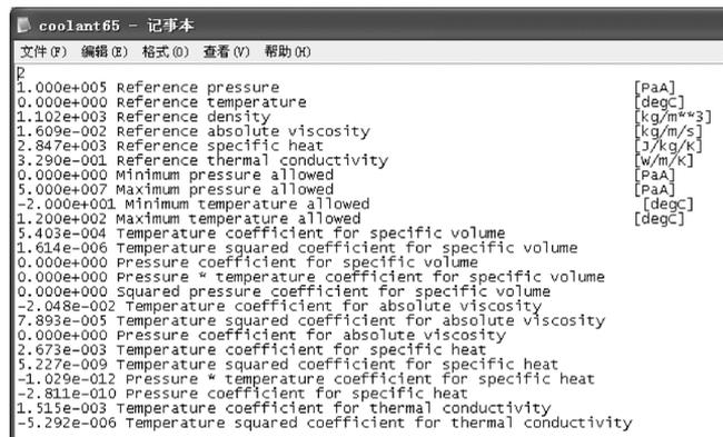
图 3 使用第一种建模方法生成的 65 号冷却液模型
