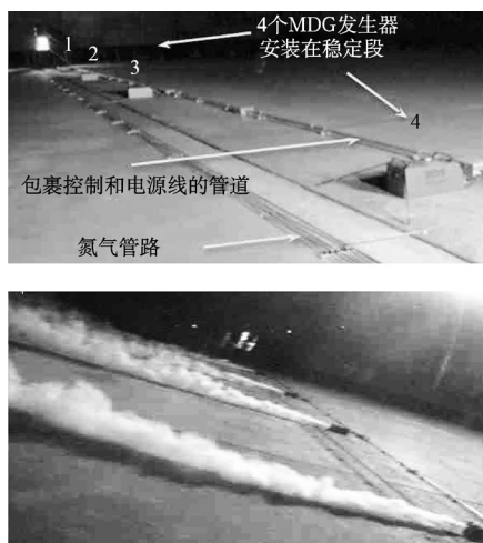
图5 示踪粒子发生器系统 Fig.5 Seeder system
