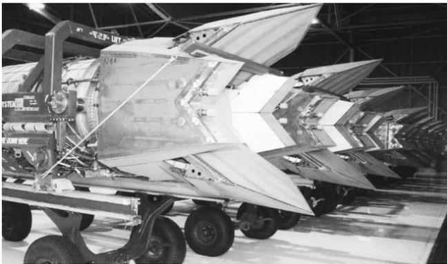
图 6 F119 发动机二维俯仰矢量喷管
