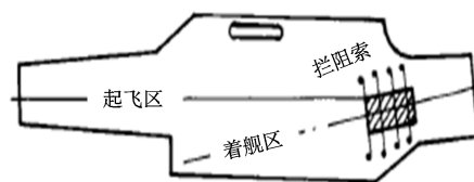
图 1 航空母舰甲板示意图 Fig.1 Diagram of carrier deck
