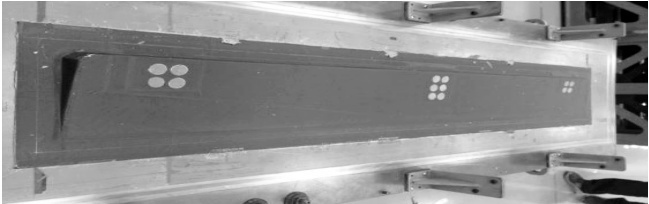
图 11 扰流板试验件 Fig.11 The spoiler testing piece
