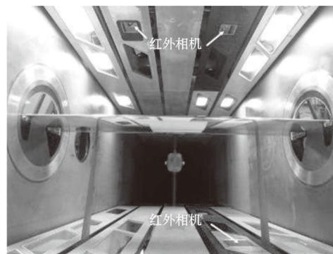
图3 风洞试验布置图
