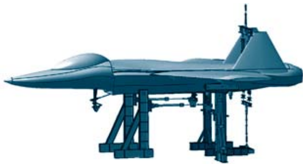
图2 前起试验支持示意图
