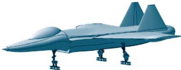
图1 地面固定支持状态示意图
