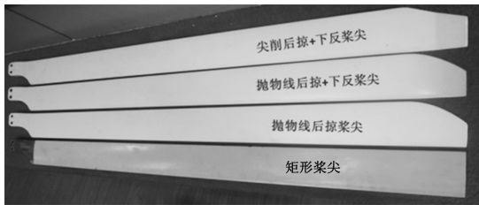
图 1 4 种桨尖形状的桨叶 Fig. 1 Four blade-tips
