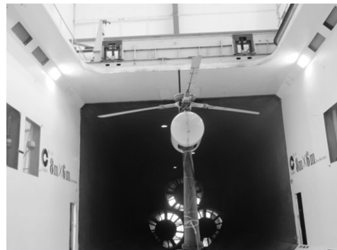
图6 无轴承模型旋翼风洞试验
